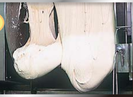
●ミキサー/はかれたパンのいろいろな原料を練り混ぜてパン生地をつくる機械
