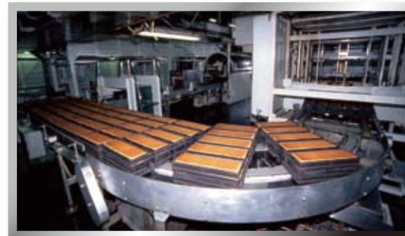
●ふたが開いて食パンの頭が見えている状態のデリッターからデバンナーの間の写真です。(この後デバンナーに送られ、型をさかさまにひっくり返して、食パンを取り出します。) ●デリッター/オープンから出た後で、食パンのふた(リッド)を外す(空ける)機械 ●デバンナー/デリッターの後で、型から食パンを取り出す機械
