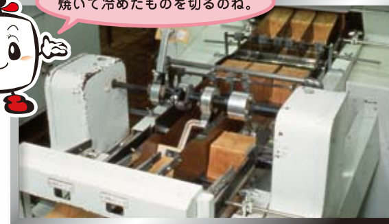
●スライサー:機械の刃を使用し、等間隔で同じ厚さに切ります。厚さは一片4枚切り、6枚切り、8枚切りによって違います。
