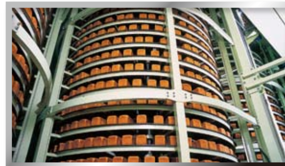
●クーリングタワー/焼きあげた場所から仕上げの場所に移動するのに使う機械:焼きあがったパンは熱いまななので、すぐには仕上げ、カット、包装の作業ができません。しばらくひやすことが必要で、移動する間にひえます。
